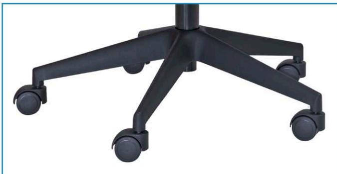
De serie incorpora base piramidal de nylon con 30% de fibra de vidrio, diámetro de 630 mm y ruedas de 50 mm de rodadura dura y un cilindro de gas con 12 cm de recorrido.
