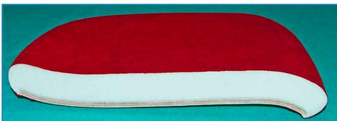
El asiento de la serie esta fabricado con espuma moldeada por inyección, libre de FCF y autoextinguible. Su densidad, superior a 55 Kg/Mc garantiza la durabilidad de la silla en la pieza que mas deterioro puede sufrir
